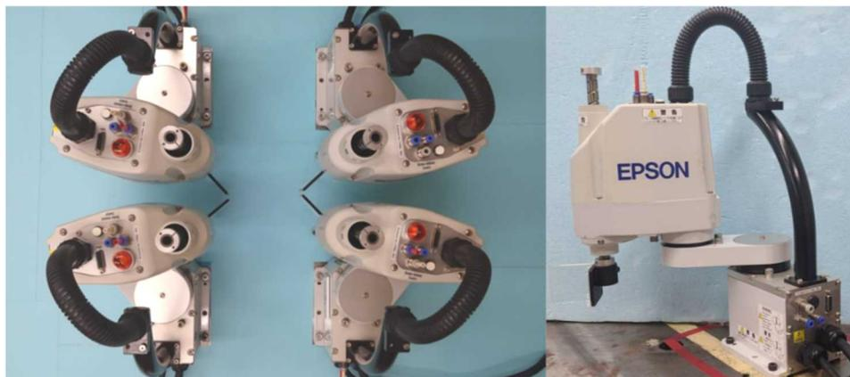
図 2 SCARA ロボットプラットフォーム
